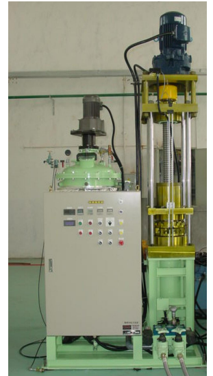
P又はF液配合用3ストリームユニット (P液は難燃材のことです)
